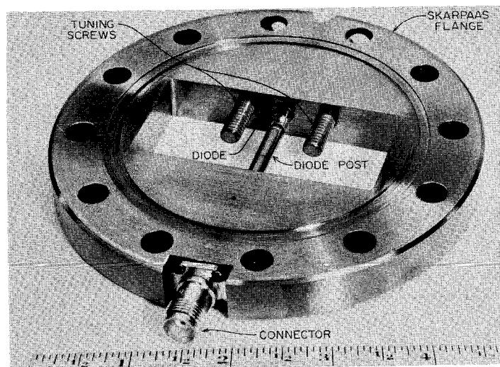
FIG. 5 - MODULATOR FLANGE
